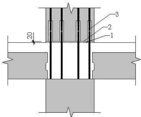
图2 预制柱套筒灌浆连接示意图
